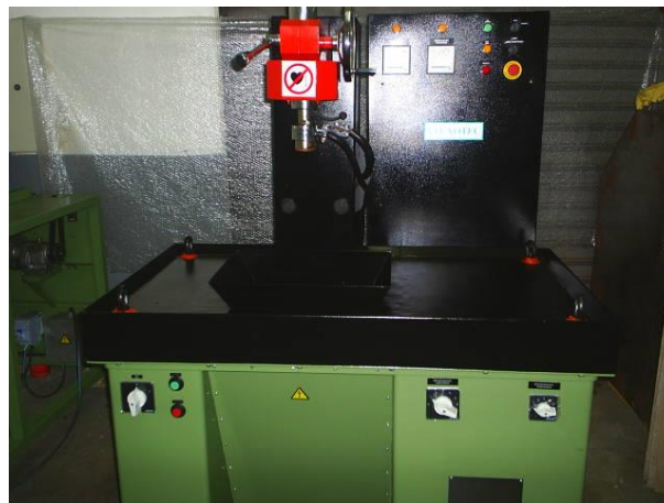
Técnica dos eletroímãs em máquina estacionária - Bobina vermelha incorporada ao cabeçote de aço da máquina vertical
