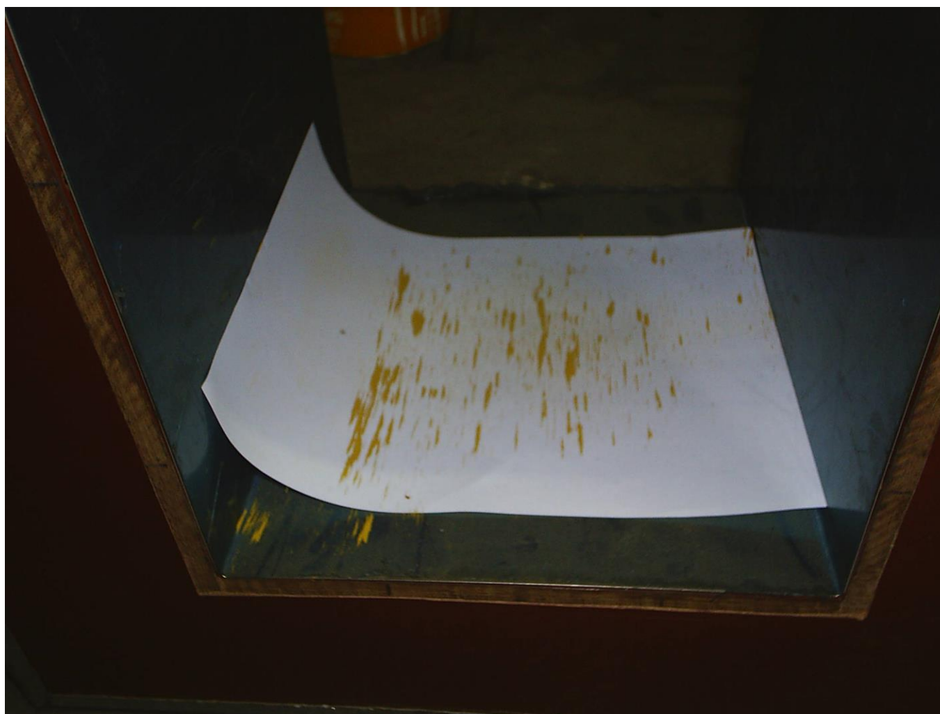
Linhas de campo magnético longitudinais dentro da bobina
