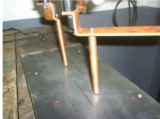
Eletrodos de contato utilizado p/ passagem de corrente
